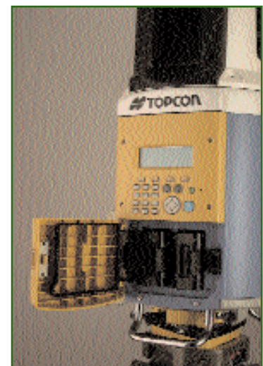
Рис. 5 Расположение аккумуляторов в сканере Торсон GLS-1000
