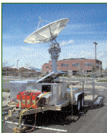
Рис. 1 Антенная система малогабаритного комплекса «УниСкан» в США
